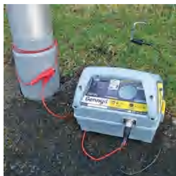
Способ трассировки кабелей малого диаметра
